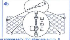
Se la plastica fosse molto tenera e si spanassero i fori allargare a mm. 8 ed utilizzare le boccole in dotazione con le apposite viti a passo metrico.
